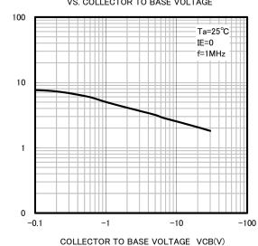
COLLECTOR OUTPUT CAPACITANCE Cob(pF)
