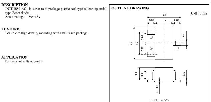
JEITA : SC-59 JEDEC: — TERMINAL CONNECTION ①: ANODE ②: NC ③: CATHODE
